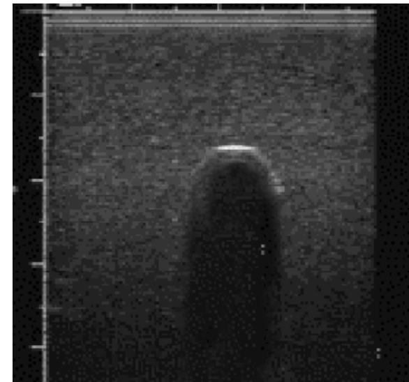
Cône d'ombre produit par une bulle d'air dans de l'eau.
